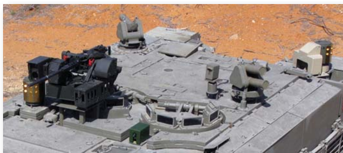
Систем активне заштите „Iron Fist“ и RCWS 12,7 mm монтирани на куполу „арцун-2“
