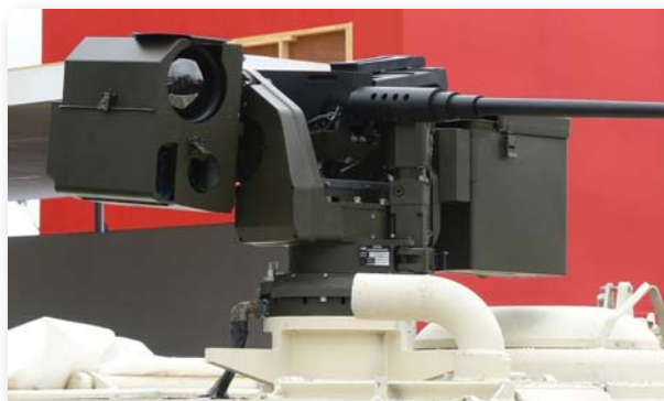
Даљински управљана оружна платформа WAVE 300 са ПАМ 12,7 mm
